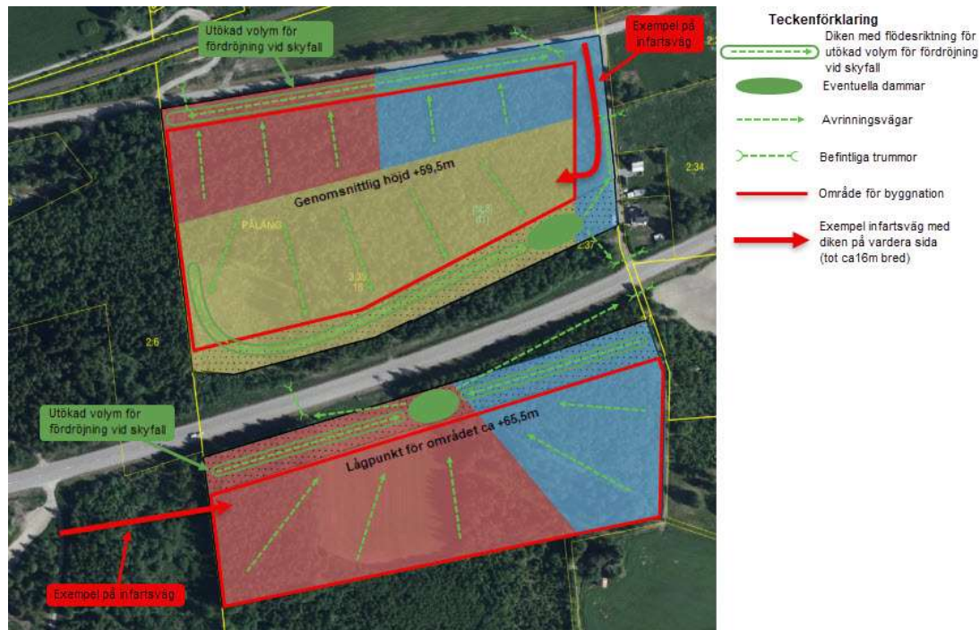
Figur 10. Exempel översiktlig dagvattenhantering och exempel på möjlig höjdsättning ur avvattningsperspektiv.
