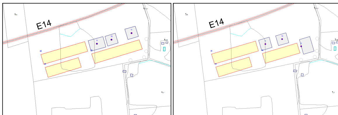
Figur 5. Modellering av det södra delområdet, med föreslagna byggnader (20 m höga), punktkällor (93 dBA, 2 m över tak) som representerar ventilationshuvor på tak samt areakällor (gula ytor: vardera 93 dBA, 2 m över mark) som representerar arbetsfordon. Vänster: Ursprungligt byggnadsförslag. Höger: Bulleranpassat, med en byggnad flyttad för att hamna mellan arbetsyta och bostad, samt med fläkten flyttad från tak till fasad bort från bostad.
