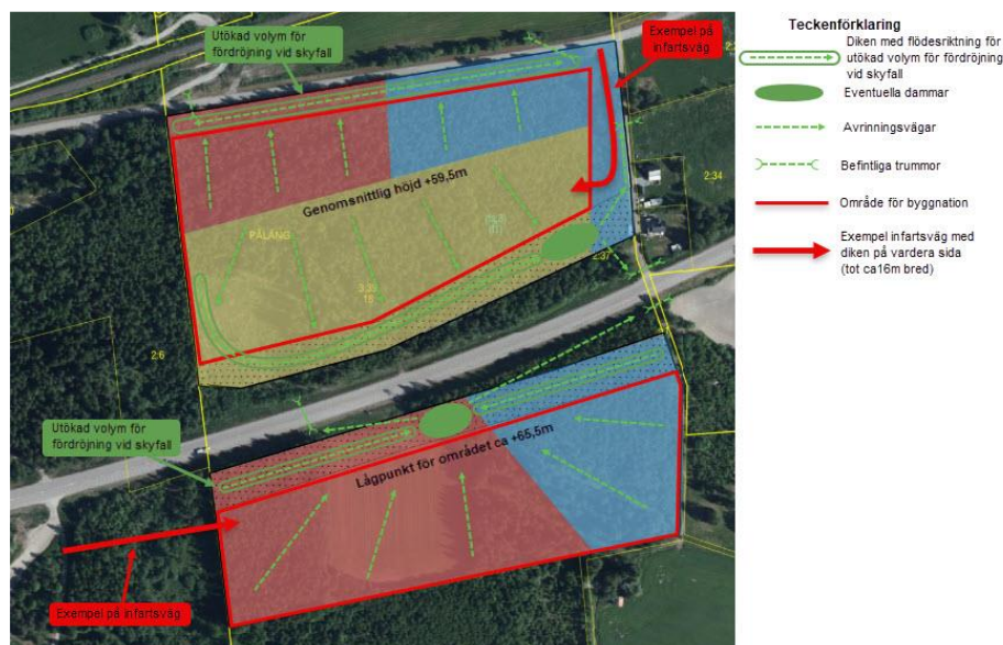
Figur 11: Bild från dagvattenutredningen som visar ett översiktligt exempel på hur en systemlösning för dagvattnet skulle kunna se ut. (Dagvattenutredning, Structor, 2025-08-19)
