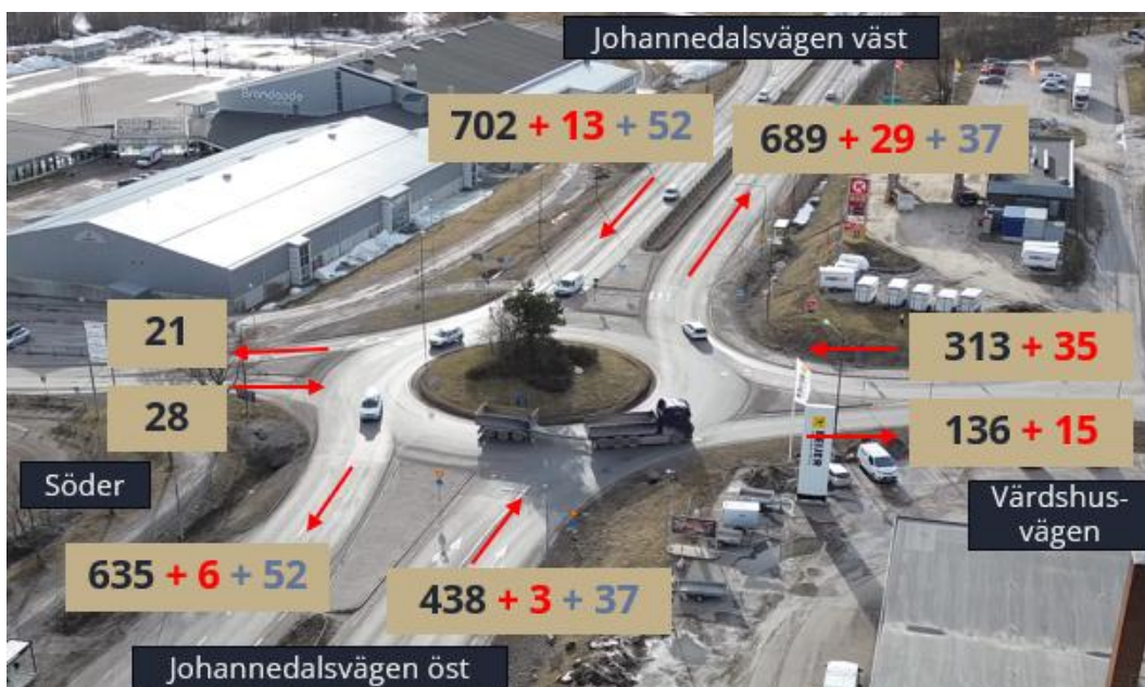
Figur 13 Trafikflöden in och ut ur cirkulationsplatsens anslutningar, prognos 2025, eftermiddagens maxtimme. Nuläge 2025 (svarta siffror), tillkommande alstring från planområdet (röda siffror), generell trafikutveckling (blå siffror).
