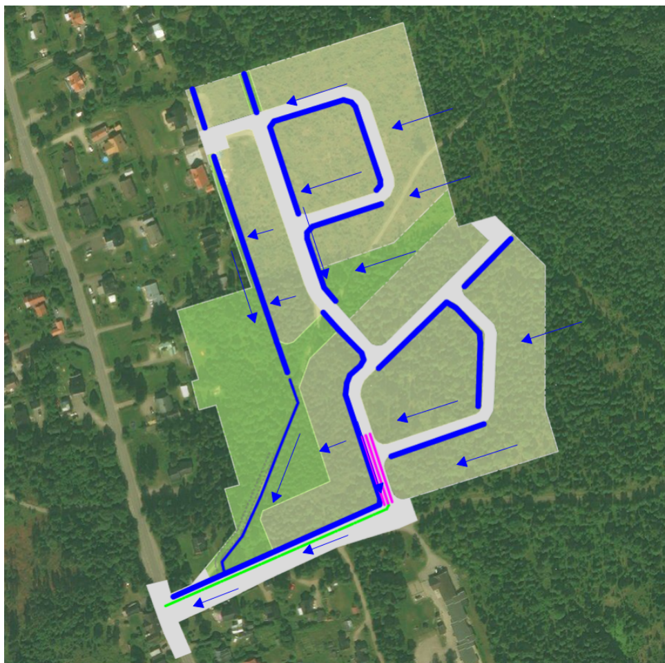
Figur 5-1 Systemlösning för alternativ 1. Blå linje avser svackdike, rosa linje avser rörmagasin och blå pilar visar avvattningsplan.
