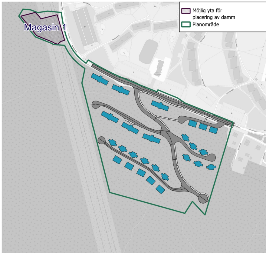
Figur 18. Figuren visar en yta vari det bör vara möjligt att placera dammen. Ytan är vald utifrån kraftledningsstolparnas placering och markens lutning.
